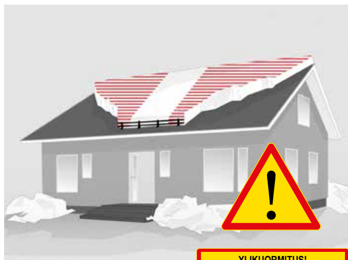
Lumiesteillä tulee estää lumen putoaminen katolta alempana olevalle lappeelle.
