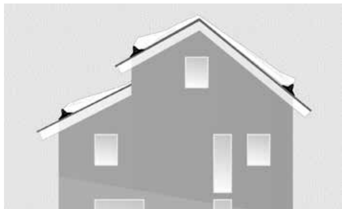
Lumiesteillä tulee estää lumen putoaminen katolta alempana olevalle lappeelle.
